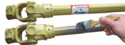
**IMPORTANT:** Éviter les dommages prématurés à l'arbre à cardan. Un arbre à cardan qui fonctionne ne doit pas dépasser un angle de 25 degrés vers le haut ou vers le bas pendant utilisation du relevage 3 points.
