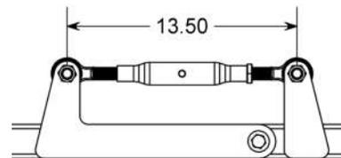
5) Installer support de câble (item 1) sur la barre d'attache intermédiaire (item A) avec la plaque pour boulon en U (item 2) et deux écrous à garniture de nylon 1/2" n.c. (item 3).
